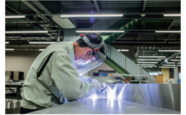
箱文字の溶接の様子
